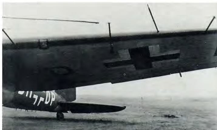
Ci-dessus : le radar FuG 213 Lichtenstein S sur un He 111H-18. L'antenne se trouve sur le bord d'attaque de l'aile. Elle détectait des navires distants de 50 km. Ci-dessous : nez d'un He 111H-18. Cet avion servit dans le KG 40, dans le golfe de Gascogne et en Méditerranée, avec le FAGr 123.
