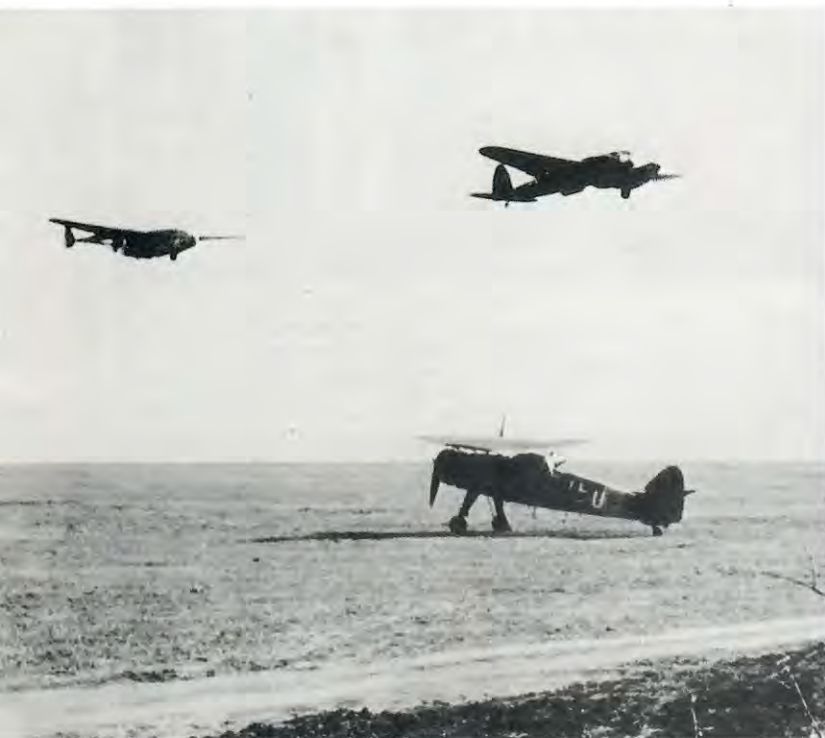
Ci-dessus : prototype du He 111H-20 utilisé pour le transport de parachutistes ou de bombes. Une tourelle électrique équipée d'une MG 131 de 13 mm y était montée.
