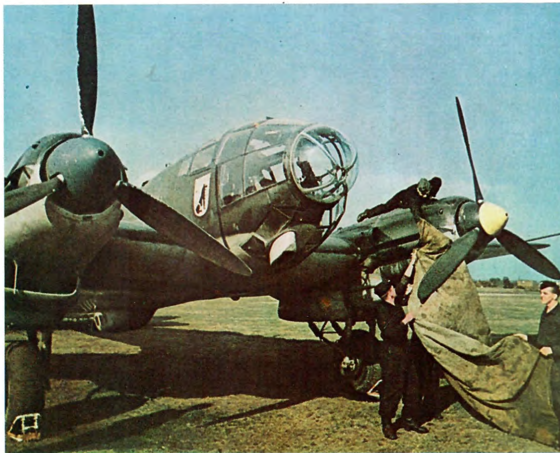
Ci-contre : He 111 du III./KG 26 préparé pour une mission. Seule la casserole d'hélice droite a la couleur jaune du Groupe et les moteurs ont les échappements du type H.
