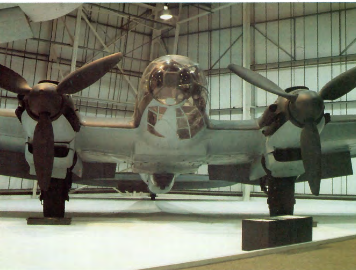
Ci-dessus : vue de face qui permet de constater l'asymétrie de la verrière.
