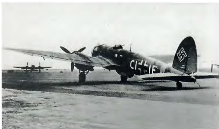
Ci-dessus : prototype du He 111H-20 utilisé pour le transport de parachutistes ou de bombes. Une tourelle électrique équipée d'une MG 131 de 13 mm y était montée.
